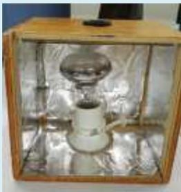
Ovoscopio casero, realizado con una caja de madera, a la que se le ha practicado un orificio en la parte superior. Alrededor del orificio se ha dispuesto una arandela de goma para apoyar el huevo. La fuente de iluminación es una bombilla de LED colocada sobre un portalámparas.
